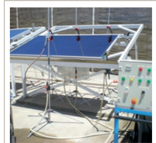
Figura 22.6. Ensayo de choque térmico externo (Laboratorio LABSOL/ITC)
